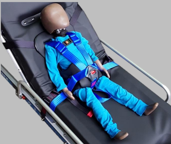
6.2. Hier abgebildet der P1,5 Dummy mit einem Gewicht von 11 kg.
