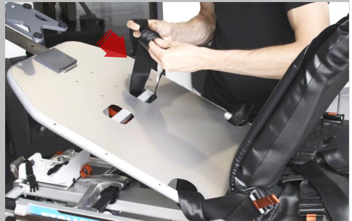
10.1. Die Schultergurte von vorne oben über die Querstrebe führen und die Gurtzunge durch die Schlaufe führen.
