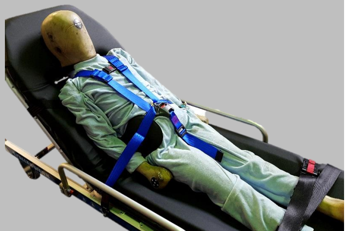
6.3. Bei älteren Kindern (hier abgebildet der P10 Dummy = 32kg) kann ein Beingurt zur weiteren Sicherung genutzt werden.
