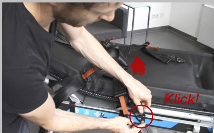
9.3. Die unteren, seitlichen Haltegurte mittels Ausklinkbeschlägen an den fußseitigen Muffen fixieren.
