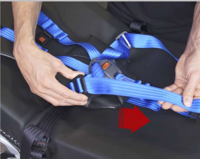
5.3. Über die Umlenkung im Beckenbereich werden gleichzeitig die Schultergurte mit gestrafft.
