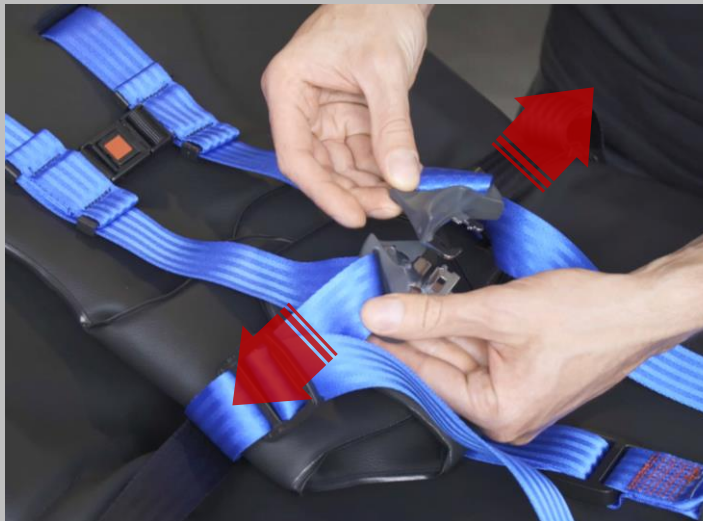
1.3. Die beiden zentralen Gurtzungen werden voneinander getrennt und auseinandergelagt.
