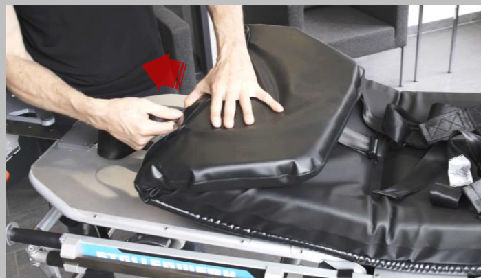
5.1. Bei vorhandener Kopfteilverlängerung, diese nach oben Schieben und die Auflage nach vorne biegen.
