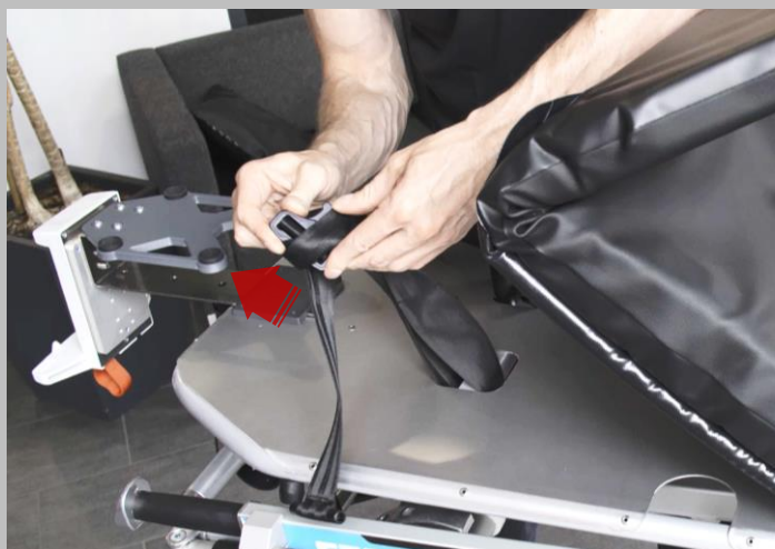
5.3. Durch die Schlaufe beide Schultergurte von der Quertraverse entfernen.
