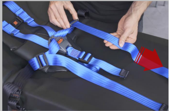
5.2. Anschließend die beiden Becken-Schulter-Gurte straffen.
