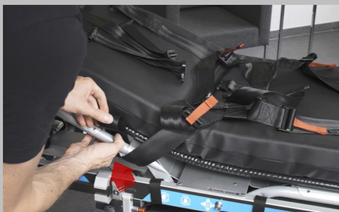
9.1. Das Gurtsystem auf der Auflage in Position legen und die seitlichen Haltegurte mit der Schlaufe von außen nach innen führen.
