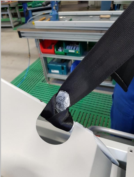
2.5. Dann den Gurt nach oben festziehen, dass sich die Schlaufe festzieht (Etikett muss nach innen zeigen).
