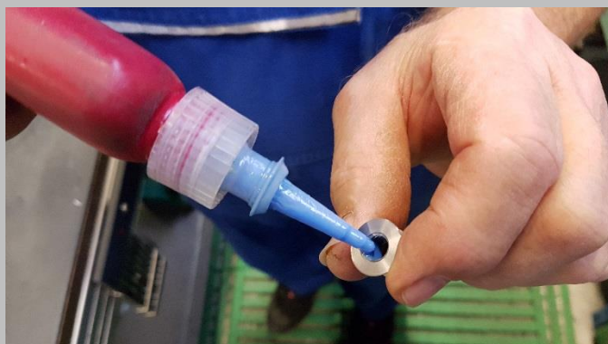
3.2. Muffe mit Schraubensicherung Loctite Blau 242 sichern.
