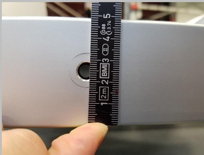
2. In der Höhe ab Unterkante Holm 25 mm. Zentral ankönnen und mit 8,1 mm durchbohren.
