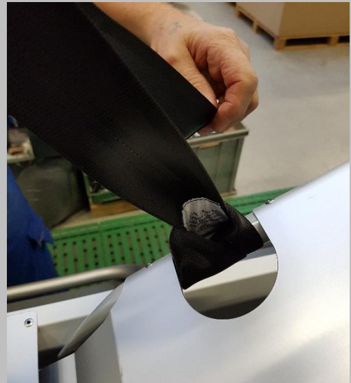
2.2. Anschließend den Gurt nach oben festziehen, dass sich die Schlaufe festzieht (Etikett muss nach innen zeigen).
