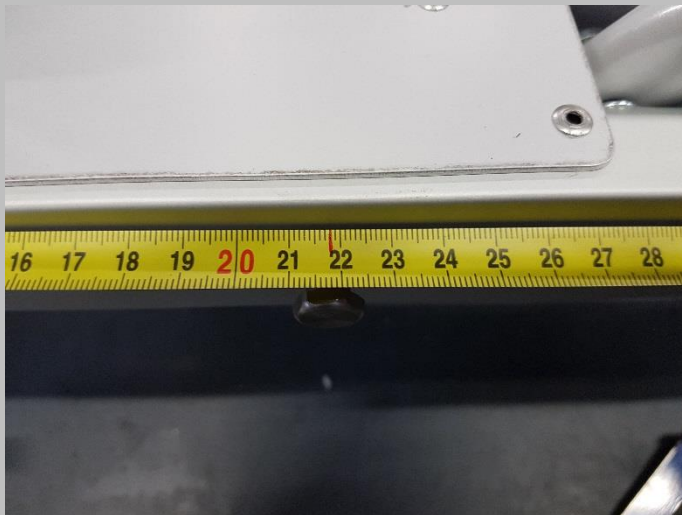
1.2. Ab kopfseitigen Seitenbügelhalter 218 mm. (Fixierpunkt für KRHS 3065 )
