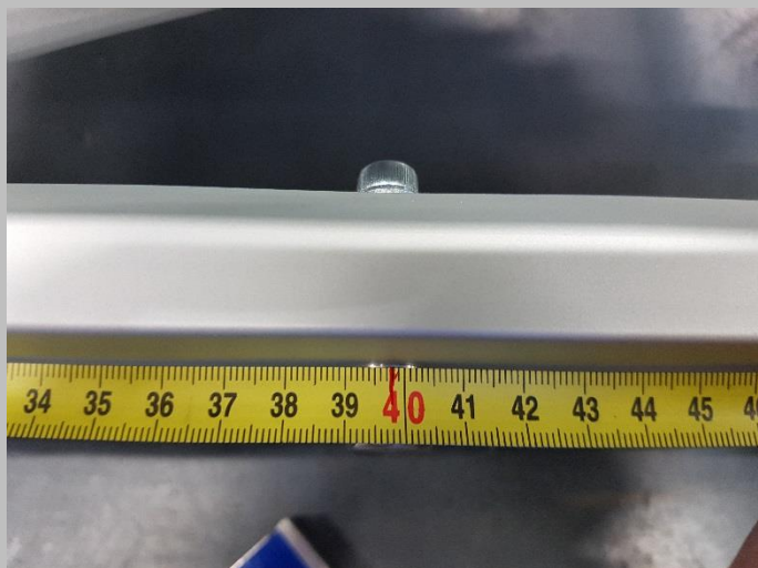
1.2. Ab kopfseitigen Seitenbügelhalter 398 mm. (Fixierpunkt für RHS 3055 )
