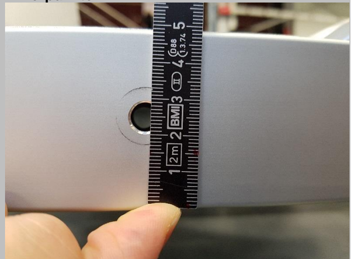
1.3. In der Höhe ab unterkante Holm 25 mm. Zentral ankörnen und mit 8,1 mm durchbohren.
