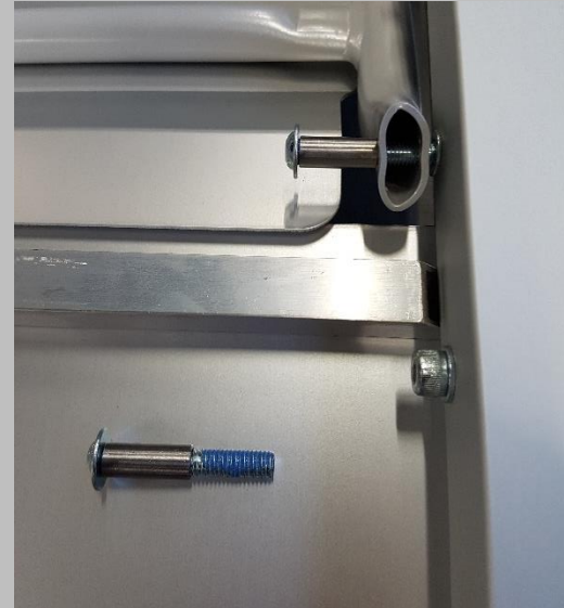
3.2. Anschließend wird das neue Befestigungsmaterial mit Loctite Blau 242 eingeschraubt.
