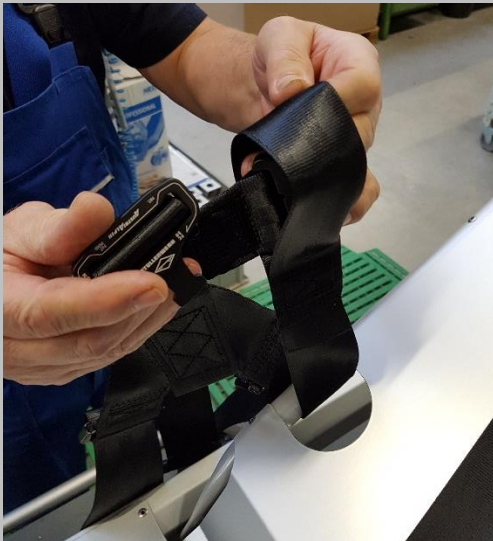
2.1. Den linken seitlichen Haltegurt mit der Schlaufe von außen nach innen führen und von der Fußseite aus die Gurtzunge durch die Schlaufe führen.
