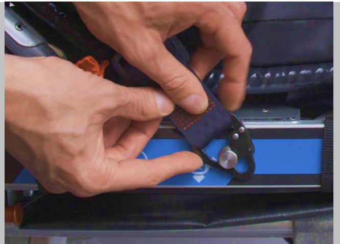
1. Untere Ausklinkbeschläge links und rechts einklinken.
