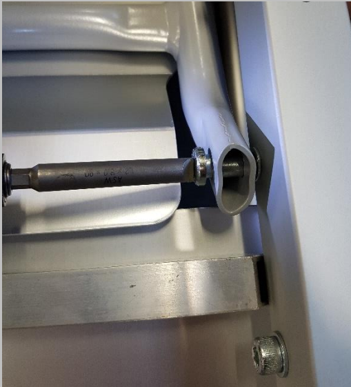
3.1. Bei Modellen 3003, 3006, 3008 wird die Schraube für die Fußhochstellung ausgetauscht. Für eine leichtere Montage kann die Krankentrage umgedreht werden.
