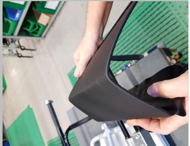
2.2. Das Gurtaufhängsystem um ca. 90° nach hinten biegen.
