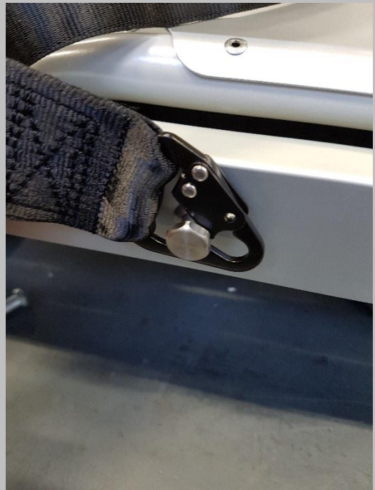
2.6. Den unteren Teil der seitlichen Haltegurte anschließend einklinken.
