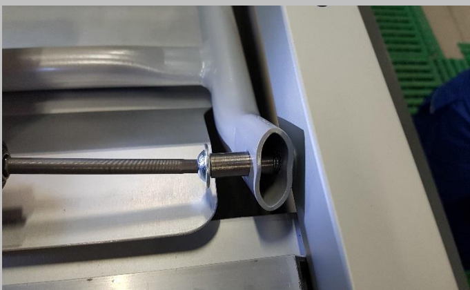
3.3. Die Linsenkopfschraube wird soweit eingeschraubt bis die Distanzbuchse am Holm anliegt.
