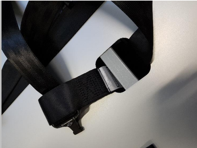
1.2. Die Gurtzunge durch die Schlaufe führen.
