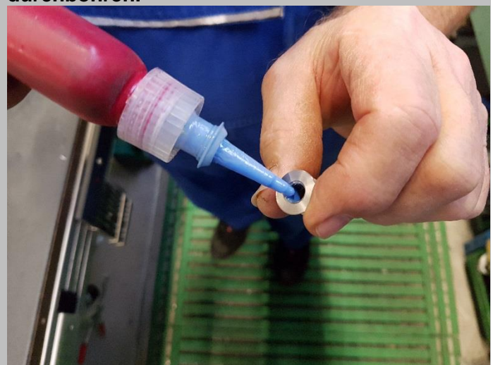
3.2. Muffe mit Schraubensicherung Loctite Blau 242 sichern.
