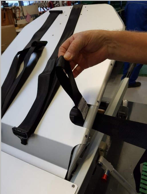
2.3. Den rechten seitlichen Haltegurt mit der Schlaufe von außen nach innen führen.
