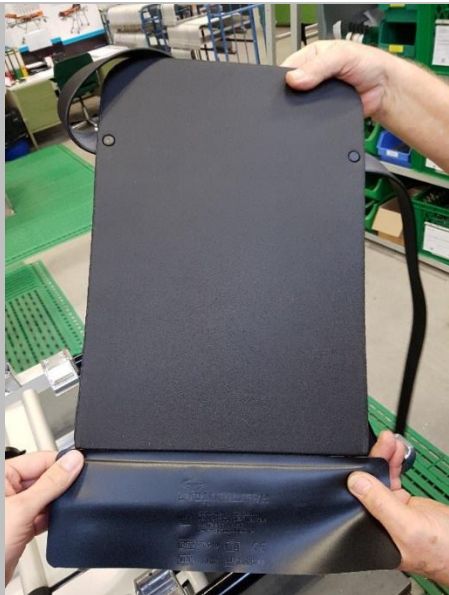
2.1. Gurtaufhängsystem mit Typenbezeichnung nach oben liegend vorbereiten.
