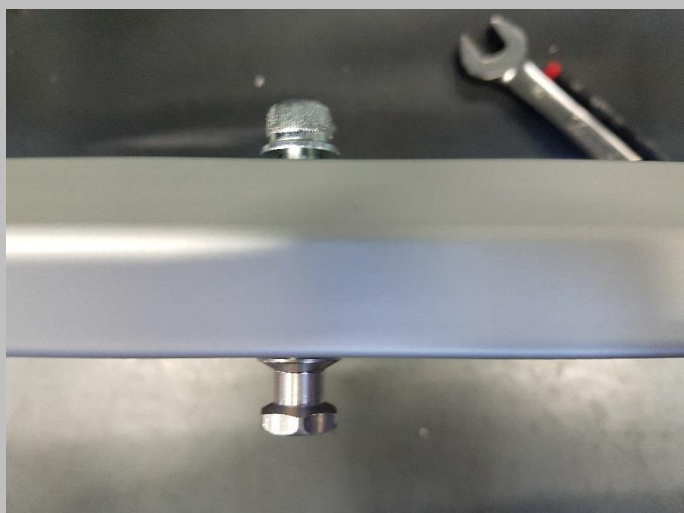
3.3. Muffe festhalten und mit Inbusschraube festziehen.
