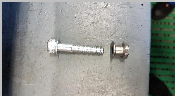
3.1. Fixiermaterial befestigen, sodass auf der Holmaußenseite die Muffe liegt und innen die Inbusschraube mit Unterlegscheibe.
