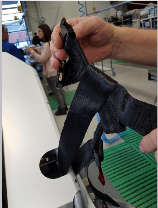
2.4. Anschließend die drei Schösser von der Fußseite aus durch die Schlaufe führen.
